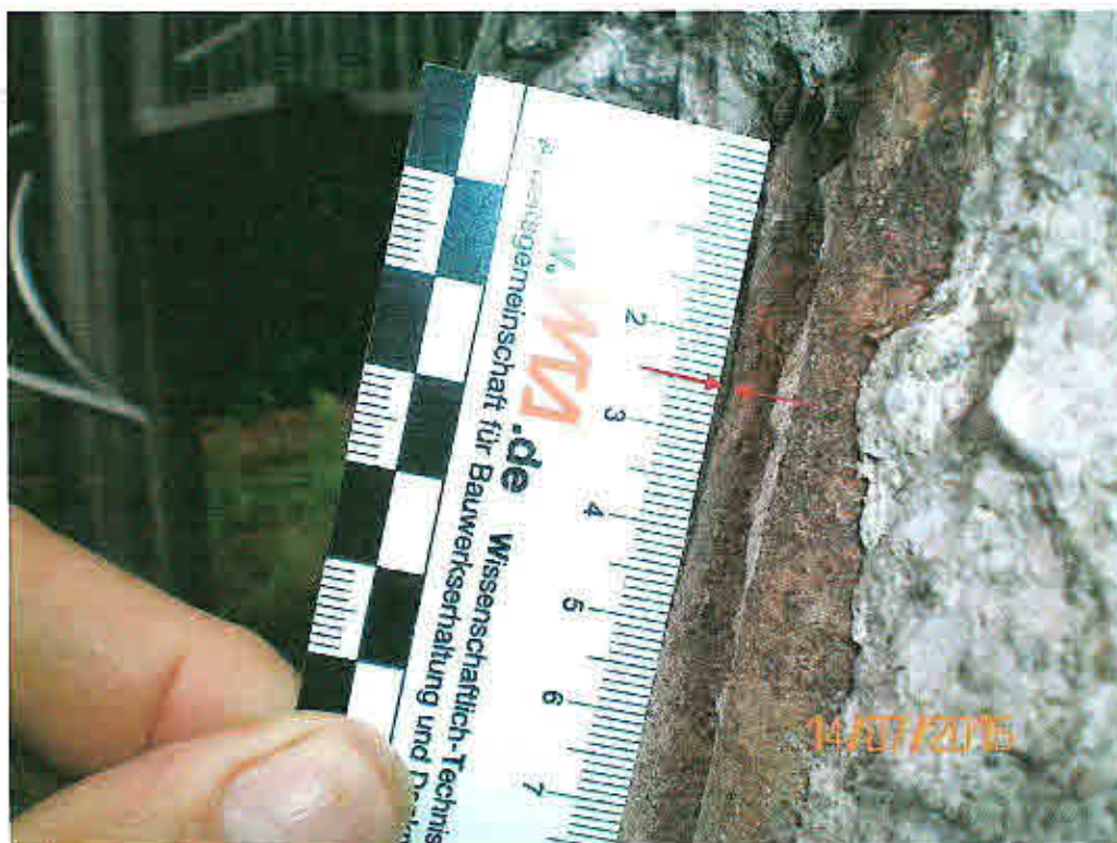
Bild 4: Maßstäbliche Darstellung Stahlverlust, OSR
