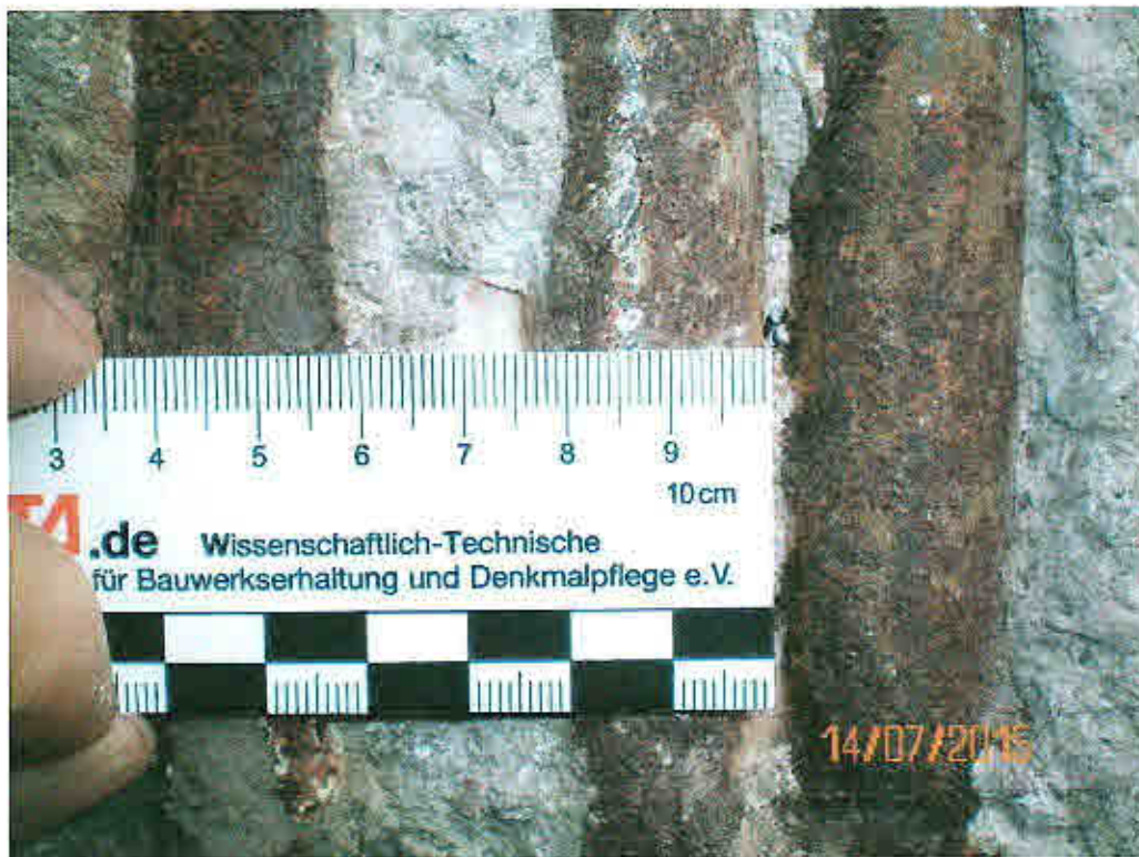
Bild 7: Maßstäbliche Darstellung Bewehrungsstahldurchmesser, OSR
